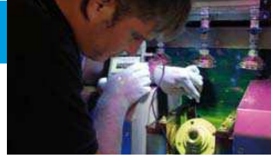
Prüfung an einer Magnetpulverprüfbank Foto: Deutsche Gesellschaft für Zerstörungsfreie Prüfung e. V.
