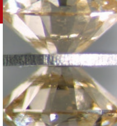
Diamantstempel zur Erzeugung sehr hoher Drücke.
